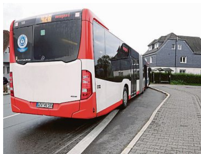
Im Ortsteil Biesfeld lässt der Schnitt der Busbucht ein Heranfahren an die Einstiegsrampe nicht zu.
